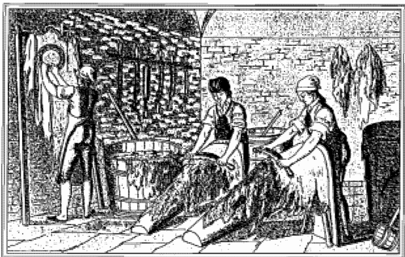
Abb. 250. Gerbereiwerkstätte, 1804. Rechts die Arbeit am «Gerberbaum» oder «Scherbock». Mit dem stumpfen «Schabmesser» oder «Streicheisen», wurden Fleisch- und Fettreste entfernt, die Oberhaut und Haare abgestreift sowie Kalkrückstände aus der Haut ausgeschabt. Der geschliffene und biegsame «Scherdegen» diente zum Entfleischen der geäscherten Häute.
