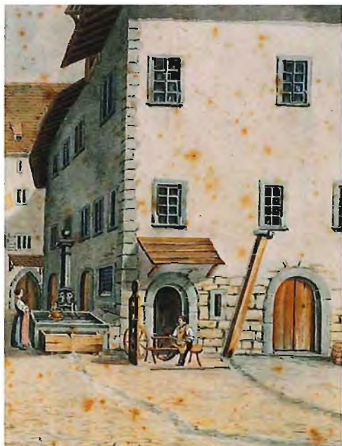
Abb. 105. Die Entsorgung des Wassers erfolgte durch den als flaches Becken gefertigten Schüttstein. Sein schnabelartiger Ausguss durchstieß die Aussenmauer und leitete das Abwasser ins Freie. Auf dem Bild ein hölzerner Ableitungskännel in der Altstadt Schaffhausens, 1843.
